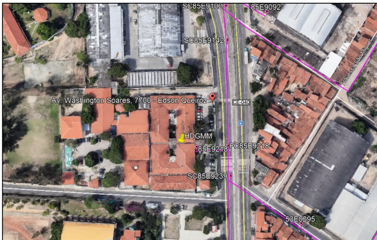
Alimentador MSD01M2, em lilás, alimentando o transformador de 225kVA do Hospital
